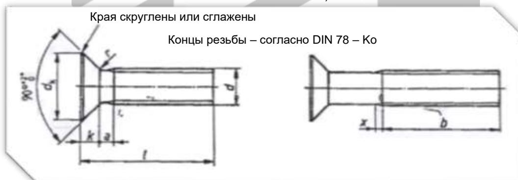
Диаметр стержня может быть равен диаметру резьбы (нормальный стержень) или приблизительно равен ее среднему диаметру (уменьшенный стержень), на усмотрение производителя.
