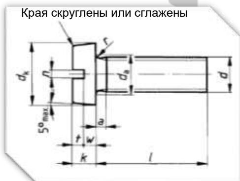
**Винты с цилиндрической головкой и резьбой на конце стержня**
