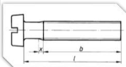
Диаметр гладкой части стержня винтов с резьбой на всей длине равен номинальному диаметру резьбы, а винтов с резьбой на конце стержня – среднему диаметру резьбы. Размеры определяет производитель.
